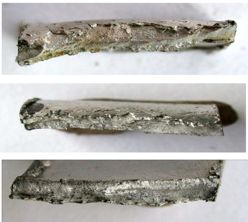
Rys.7. Makroskopowy obraz złomów belki samochodowej po kolizji drogowej
