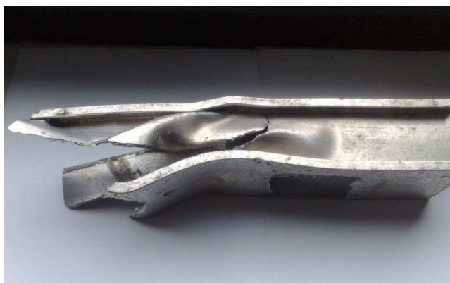
Rys. 6. Fragment belki skrętnej w obszarze uszkodzenia spowodowanego kolizją drogową
